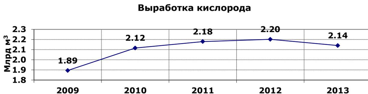
Снижение выработки кислорода в 2013 году по сравнению с 2012 годом на 0,06 млрд м<sup>3</sup> (-2,77%) связано с проведением капитального ремонта доменной печи №6 с августа по декабрь 2013 года.
