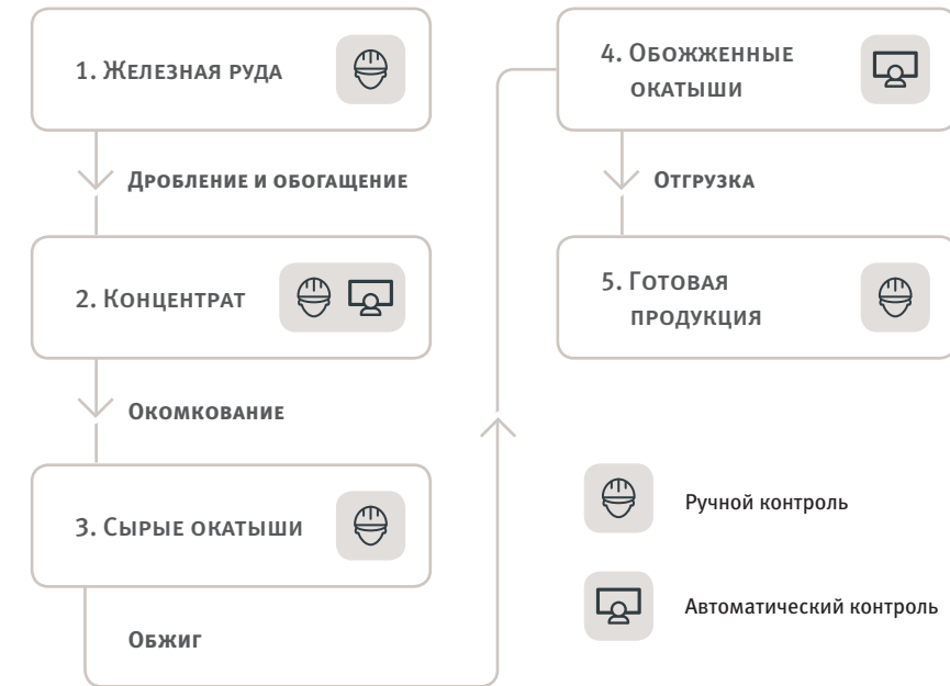
Схема процесса производства окатышей с указанием методов контроля качества технических параметров
