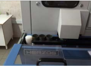
Загрузка стаканов в автом систему пробоподготовки
