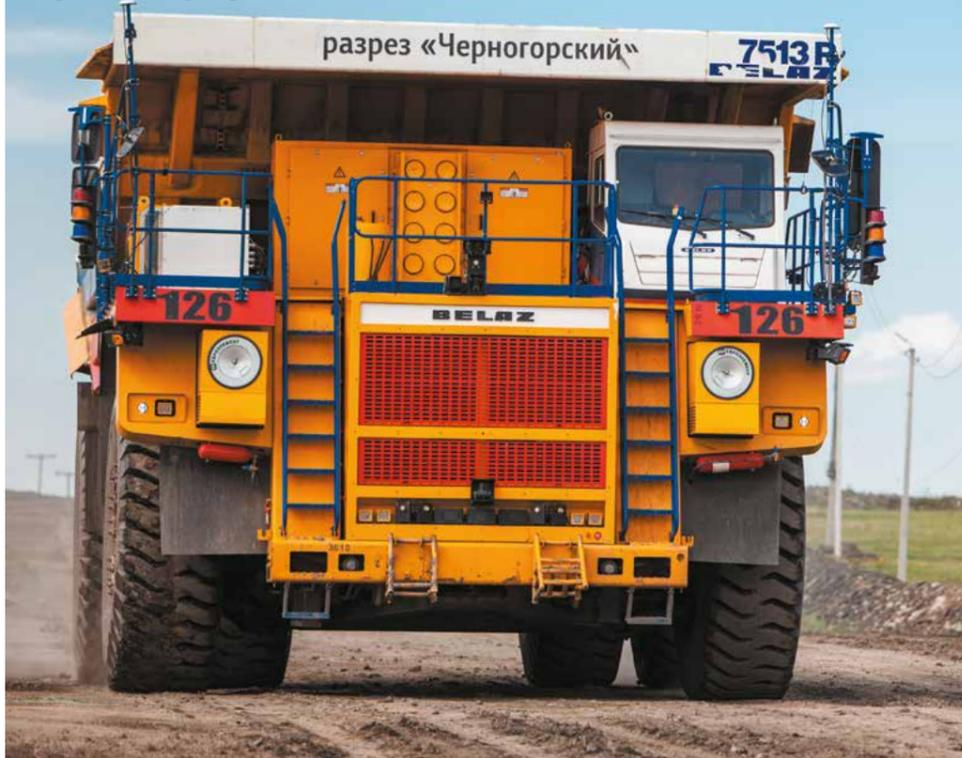
С 2017 года на разрезе «Черногорский» в Хакасии реализуется инновационный проект «Автоматизированная система грузоперевозок на основе роботизированных самосвалов БЕЛАЗ-7513R». Технология, первая в своем роде на предприятиях СУЭК, направлена на повышение эффективности оборудования и безопасности горных работ.
