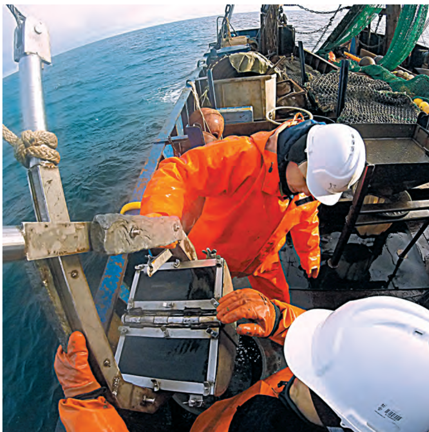
Рисунок 9–9. Отбор донных отложений дночерпателем
