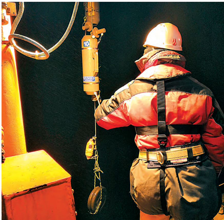
Рисунок 9-7. Отбор проб морской воды батометром Нискина, закрывающимся с помощью посыльного груза
