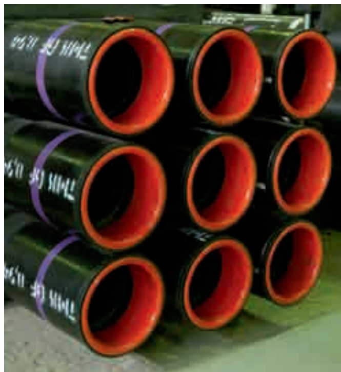
Нефтегазовые бесшовные нарезные трубы (ОСТГ)
