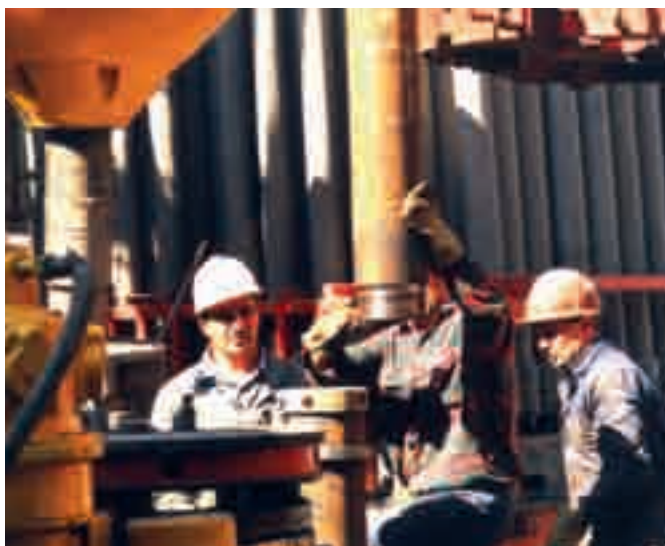
Спуск обсадной колонны
