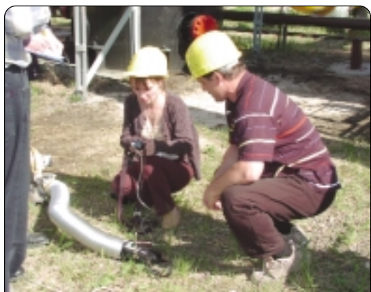
Объемный замер эмиссии метана на блоке очистки и осушки газа
