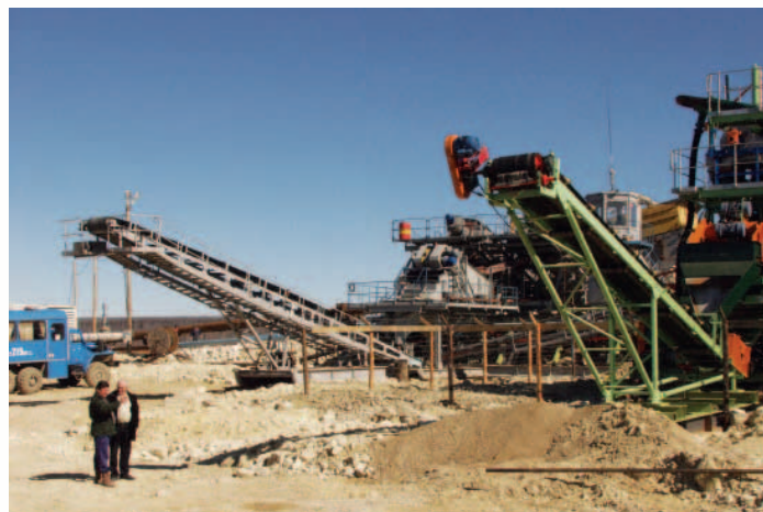
Мобильная установка первичного обогащения песков КСА-100 в Анабарском ГОКе
