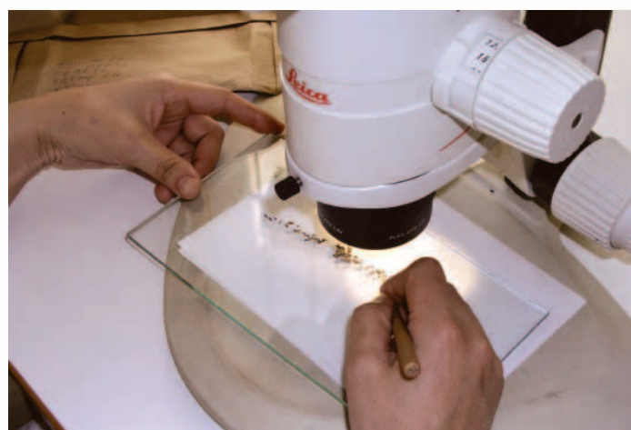
Минералогический анализ шлиховых проб в центральной аналитической лаборатории БГРЭ
