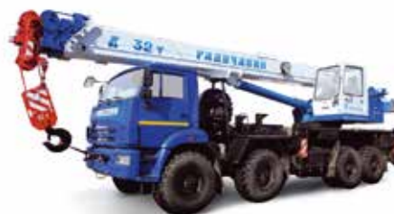
КС-55729-5В (г/п 32 тонны) на шасси КАМАЗ-63501 (8x8)
