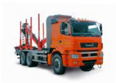
Сортиментовоз на шасси КАМАЗ-6580 с ГМУ (V груза 23,2 м 3 )
