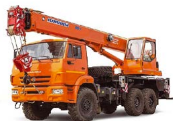
КС-35719-7-02 (г/п 16 тонн) на шасси КАМАЗ-43118 (6x6)
