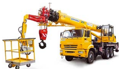
ПКК-55713-4К-4В (г/п 25 тонн) на шасси КАМАЗ-65115 (6x4)
