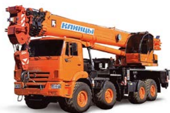
КС-65719-3К-1 (г/п 40 тонн, стрела 31 м) на шасси КАМАЗ-63501 (8x8)
