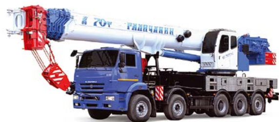
КС-75721-1 (г/п – 70 тонн) на шасси КАМАЗ-7330 (10x4)
