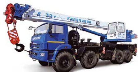
КС-55729-5В (г/п 32 тонны) на шасси КАМАЗ-63501 (8x8)
