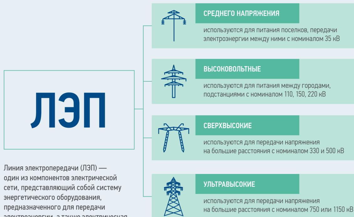
Линия электропередачи (ЛЭП) — один из компонентов электрической сети, представляющий собой систему энергетического оборудования, предназначенного для передачи электроэнергии, а также электрическая линия в составе такой системы, выходящая за пределы электростанции или подстанции.
