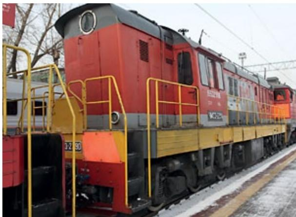
Еще одним перспективным способом снижения расхода топлива является создание маневровых тепловозов с несколькими силовыми установками. Здесь эффект достигается за счет того, что маневровый тепловоз большую часть рабочего времени не использует свою полную мощность. При наличии на тепловозе одного дизеля большой мощности он работает на энергетически невыгодных режимах и, как следствие, перерасходует дизельное топливо.
