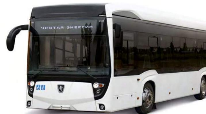
Электробус оснащен литий-титанатными аккумуляторными батареями. Этот вид накопителя, помимо мощности и компактности, отличается высокой экологической безопасностью. Машина, оснащенная подобным накопителем, может работать даже в сложных погодных условиях, а подзарядка батареи осуществляется при температуре от -40 °С без дополнительных систем подогрева. Таким образом, КАМАЗ-6282 может перевозить пассажиров в любое время года.
