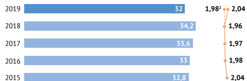
ДИНАМИКА УДЕЛЬНОЙ ЭМИССИИ CO 2 ПО ГРУППЕ НЛМК В 2015–2019 ГОДАХ, Т/Т СТАЛИ 1 GRI 305-4
