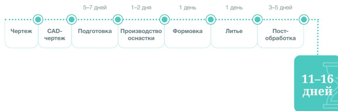
3D-принтеры центра будут использоваться для изготовления форм для отливки деталей с применением технологии струйной печати посредством нанесения порошка и склеивания его связующим веществом. Раньше такие формы изготавливались при помощи деревянной модельной оснастки.
